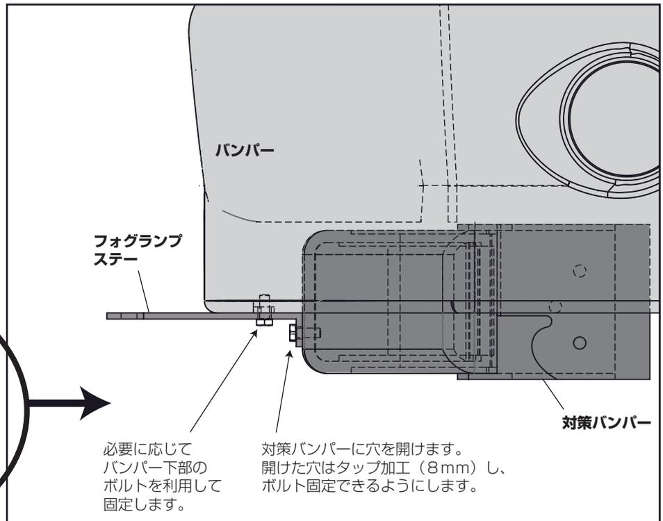
必要に応じてバンパー下部のボルトを利用して固定します。
