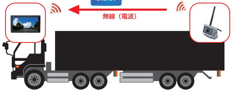
※カメラには電源線及びペアリング信号線があります。特に電源線のプラス線はアクセサリ電源等に繋ぐ必要があります。
