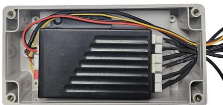
5) 蓋をSUS半ネジで締めて防水ケースを固定します。配線を通した穴を下向きに固定し、水が入り込まないようにシーリング等で防水処理を行ってください。
