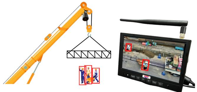
1つのモニターに対して4つのカメラをペアリングできます。モニターは2分割・4分割表示が可能。1度ペアリングしたカメラとモニターは、次回電源ON時に自動でペアリングを行います。作業現場に応じて最適な現場環境を築くことができます。
